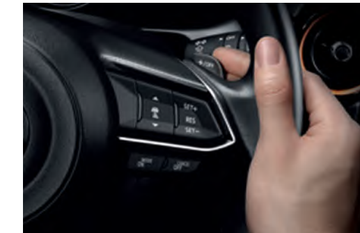
ระบบควบคุมการเปลี่ยนเกียร์ที่พวงมาลัย Sports Paddle Shift
