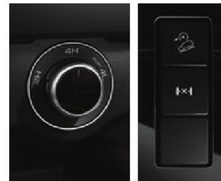
สวิตช์ระบบขับเคลื่อน 4 ล้อ และระบบ Electronic Diff-Lock ที่เพื่องท้าย
