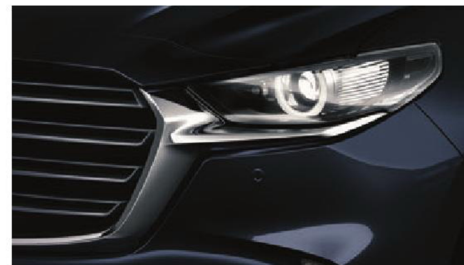
ไฟหน้าโปรเจกเตอร์ แบบ LED และไฟส่องสว่างสำหรับการขับขี่เวลากลางวัน แบบ LED Signature
